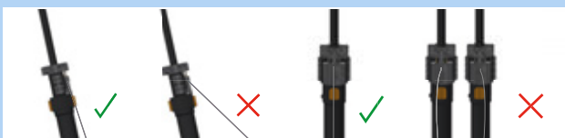
199 paveikslėlis. Teisingas ir neteisingas Bowdeno trosu traukimas
