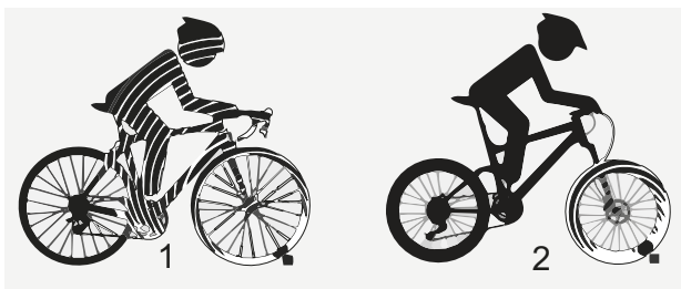
7 paveikslėlis. Be amortizatorių (1) ir su amortizatoriais (2)
