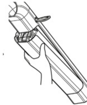
137 paveikslėlis. Akumulatorius atrakintas
