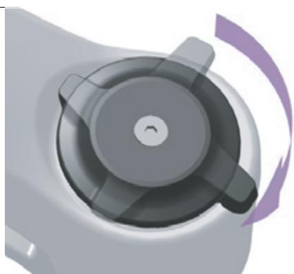
239 paveikslėlis. Kompresijos reguliatorių nustatykite kietesnėje padėtyje
