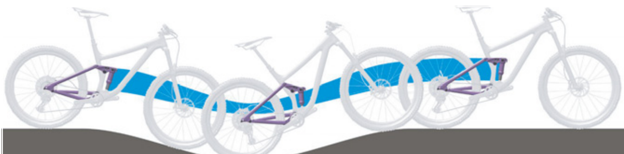
246 paveikslėlis. Ant kalno galinio amortizatoriaus amortizavimas per minkštas
