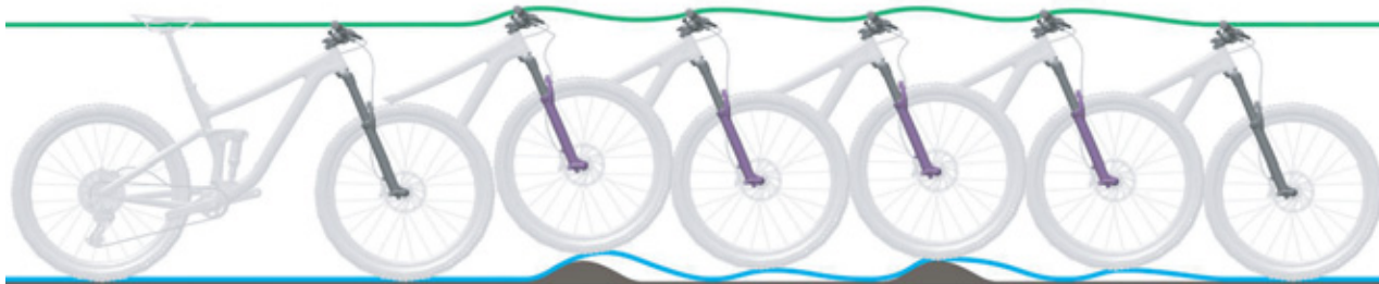
234 paveikslėlis. Per greitas amortizuojančių šakių atšokimas
