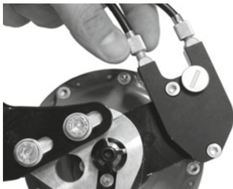
165 paveikslėlis. „Rohloff“ stebulės variantas su išoriniu perjungimo valdymu turi traukimo reguliatorius ant kabelių dėžės, kuri yra kairėje
