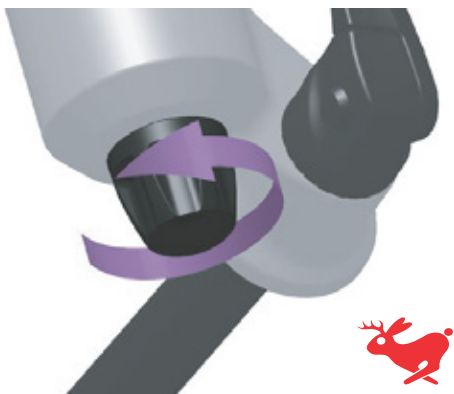
237 paveikslėlis. Pasukite įtempimo žingsninį varžtą kiško kryptimi
