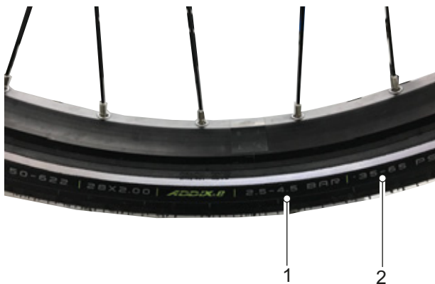
158 paveikslėlis. Užpildymo slėgis barais (1) ir psi (2)
