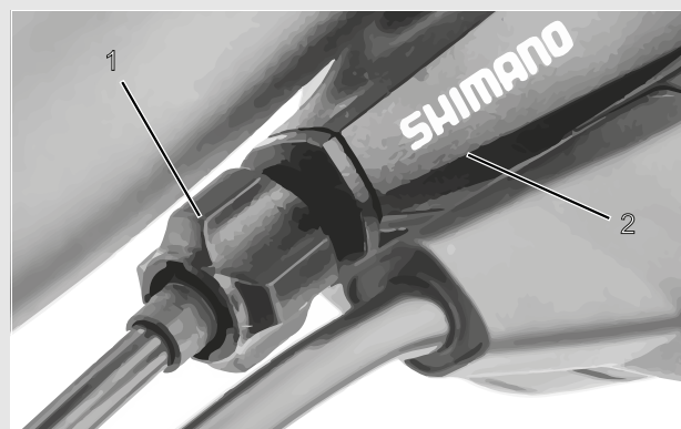
Afbeelding 103: Afstelwartel (1) van de versnelling met enkele bowdenkabelbediening en behuizing van de schakelhendel (2), voorbeeld
