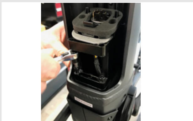
Afbeelding 28: 4 mm zeskantschroeven verwijderen
