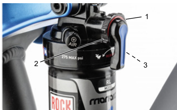
Afbeelding 96: Hardheid van de trekdemper afstellen met het afstelwiel (1) van de achterbouwdemper
