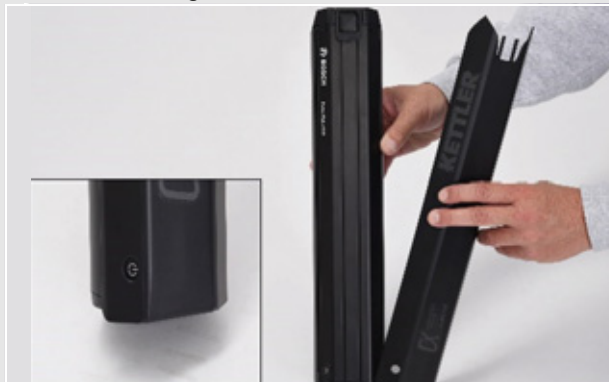
Afbeelding 35: Accuafdekking op de accu schuiven
