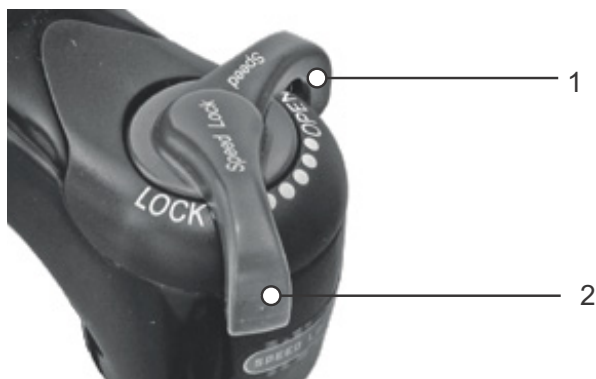
Afbeelding 95: Suntour drukdemperafsteller met de standen OPEN (1) en LOCK (2)
