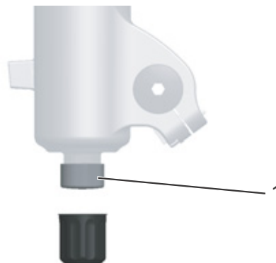
Afbeelding 74: FOX trekdemperafsteller (1) op het uitvaleinde van de vork
