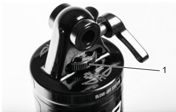
Afbeelding 75: Wiel (1) van de Suntour trekdemperafsteller op de achterbouwdemper
