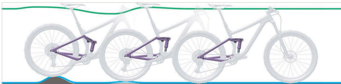
Figura 511: Corsa di estensione troppo veloce dell'ammortizzatore del carro posteriore
