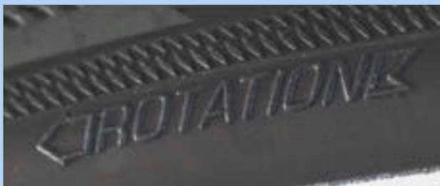
Figura 170: Freccia del senso di rotazione
