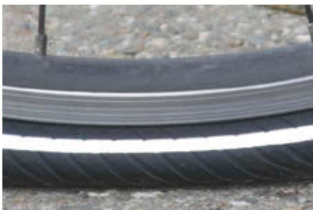
**Figura 217: Pressione di gonfiaggio insufficiente**
