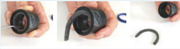
Figura 447: Rimozione dell'anello di feltro
