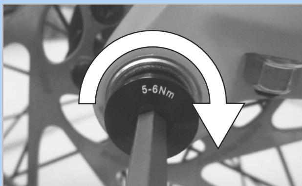
Figura 175: Serraggio della vite di sicurezza
