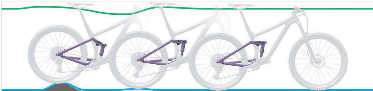
Figura 503: Corsa di estensione troppo veloce dell'ammortizzatore del carro posteriore
