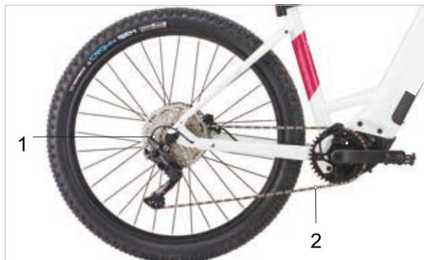
Figura 73: Schema della struttura a catena con cambio a catena
