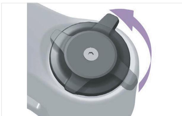
Figura 484: Regolazione più morbida del regolatore dello stadio di compressione
