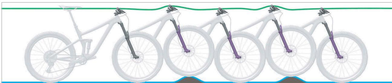
Figura 26: Comportamento di marcia ottimale della forcella ammortizzata
