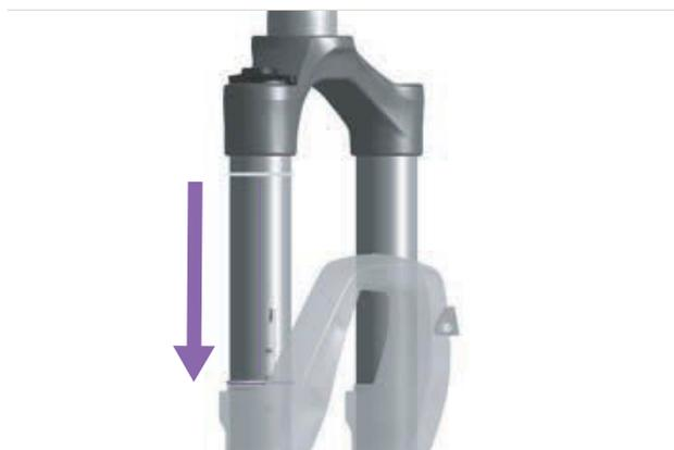
Figura 234: Spostamento dell'O-ring sulla forcella ammortizzata
