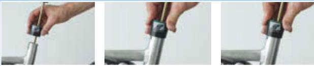
Figura 433: Applicazione della boccola esterna
