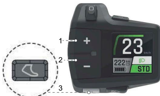
Figura 338: Ubicazione del tasto più (1), del tasto meno (2) e del tasto della funzione di assistenza di spinta (3)
