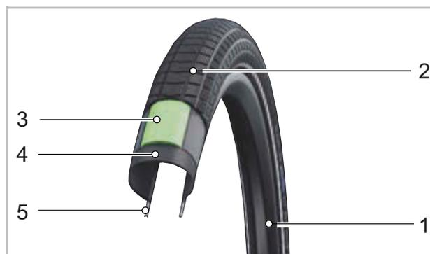
Figura 43: Struttura degli pneumatici aperti
