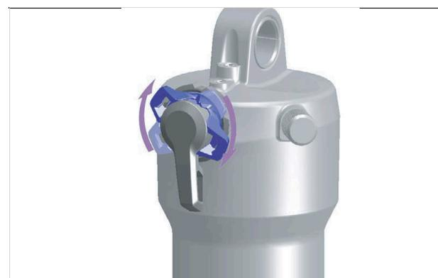
Figura 314: Regolazione più rigida del regolatore dello stadio di compressione
