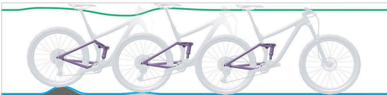
Figura 495: Corsa di estensione troppo veloce dell'ammortizzatore del carro posteriore
