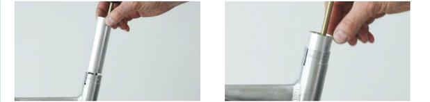
Figura 432: Inserimento del tubo del manicotto scorrevole nel canotto della sella
