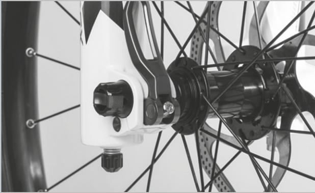
Figura 398: Regolazione della forza di serraggio del bloccaggio rapido
