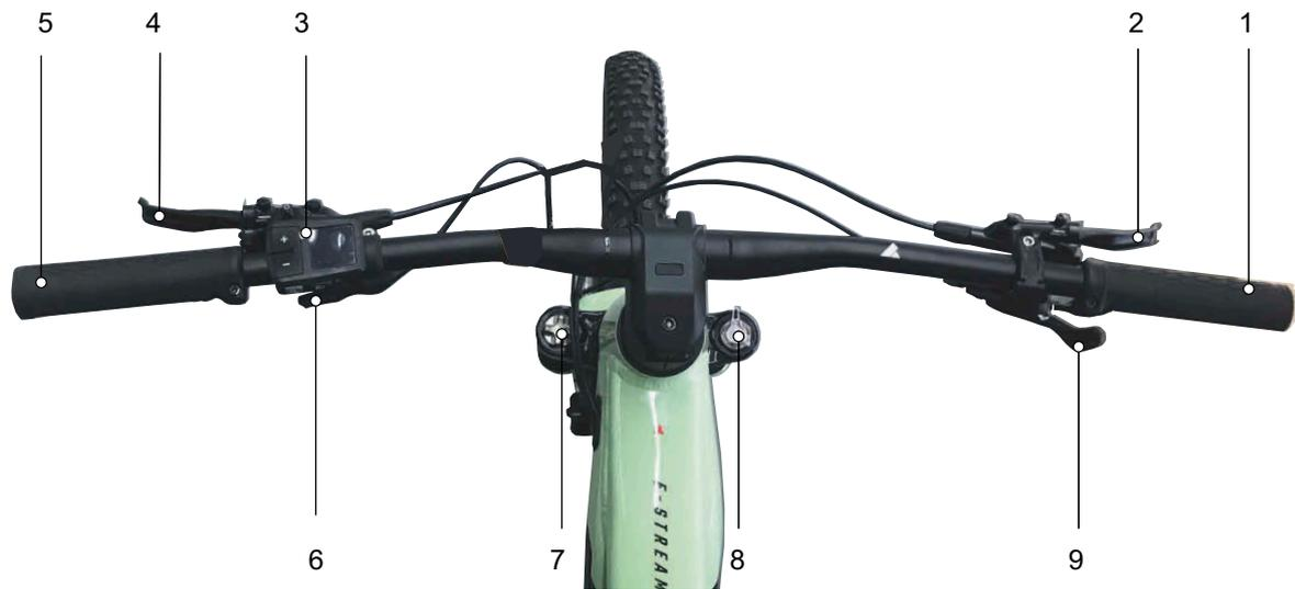
Figura 146: Particolare del manubrio con FIT LED Remote, esempio
