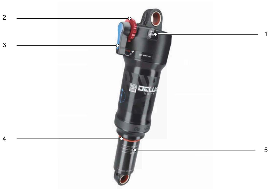
Figura 11: Struttura ammortizzatore del carro posteriore ROCKSHOX Deluxe Select +
