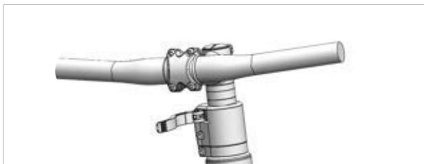
Figura 303: Esempio: All Up con leva di serraggio dell'attacco manubrio aperta
