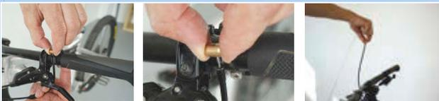
Figura 440: Sbloccaggio del telecomando
