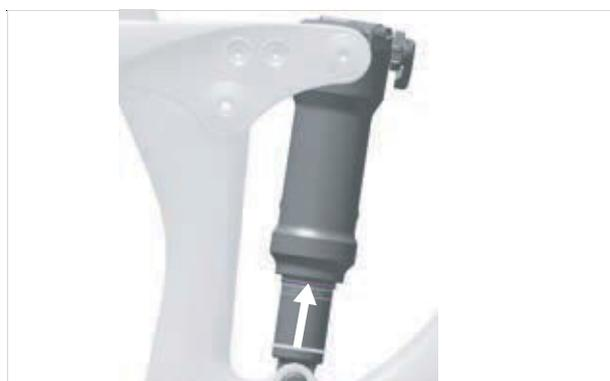
Figura 248: Spostamento dell'O-ring sull'ammortizzatore del carro posteriore
