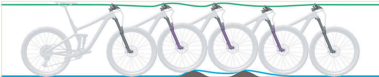
Figura 479: Corsa di estensione troppo lenta della forcella ammortizzata
