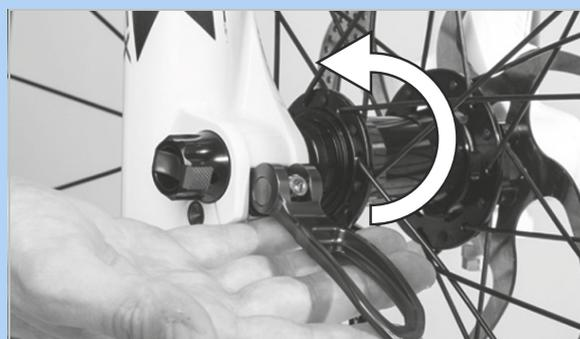
Figura 179: Spinta della leva del bloccaggio rapido nel verso della freccia
