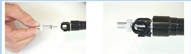
Figura 418: Avvitamento dell'adattatore della valvola
