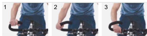
Figura 309: Posizione di presa sul manubrio multiposizione
