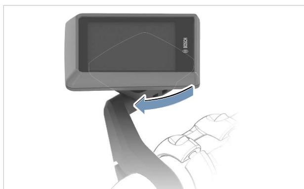
Figura 269: Rotazione del display in senso orario
