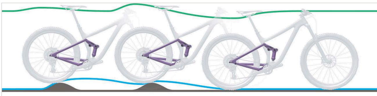
Figura 505: Corsa di estensione troppo lenta dell'ammortizzatore del carro posteriore
