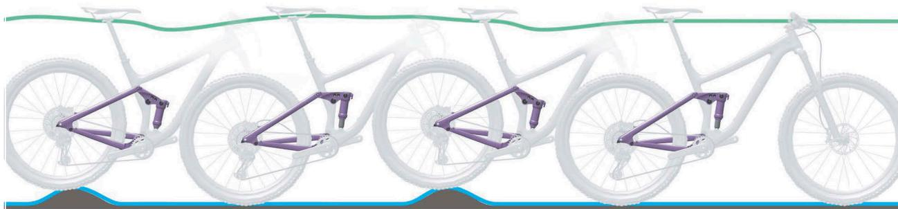
Figura 9: Comportamento di marcia ottimale dell'ammortizzatore del carro posteriore
