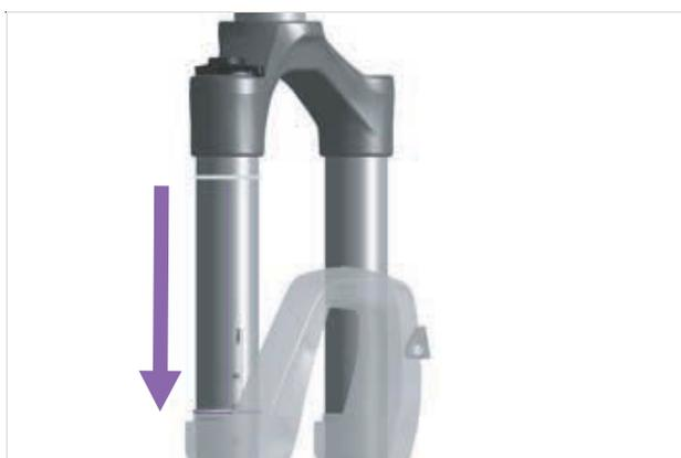
Figura 237: Spostamento dell'O-ring sulla forcella ammortizzata
