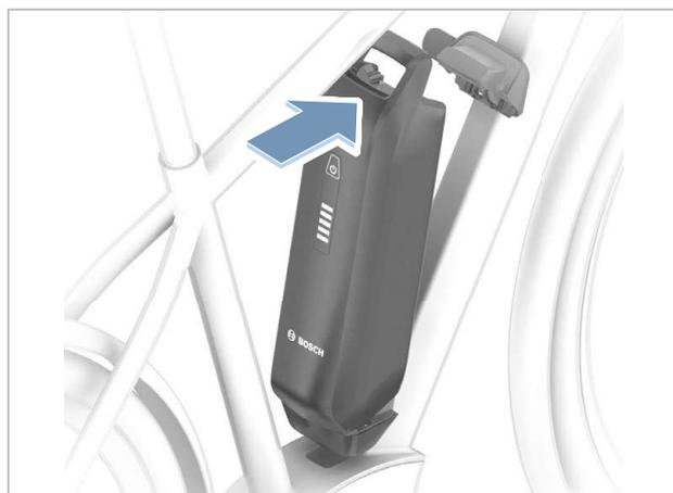
Figura 300: Ribaltamento della batteria PowerPack verso l'alto
