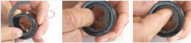
Figura 414: Applicazione dell'anello di feltro
