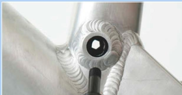
Figura 461: Foro dell'interfaccia Postpin
