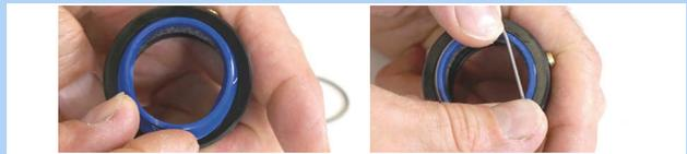
Figura 450: Applicazione e fissaggio del parapolvere
