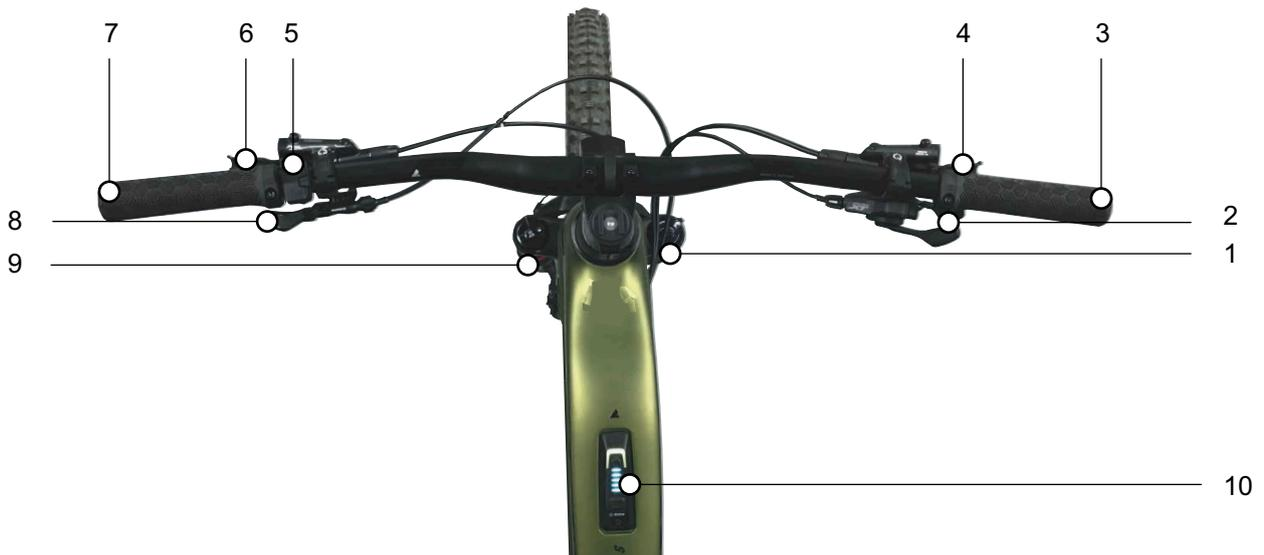
Figura 121: Particolare del manubrio con computer di bordo BOSCH System Controller e terminale di comando Mini Remote, esempio
