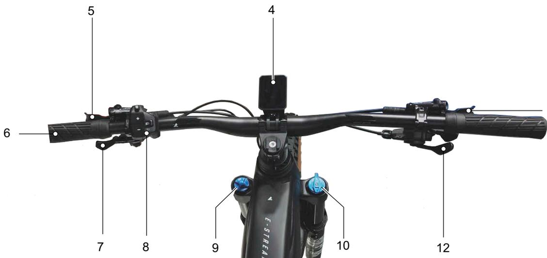
Figura 127: Particolare del manubrio con computer di bordo FIT Remote Basic e display Compact 2.0
