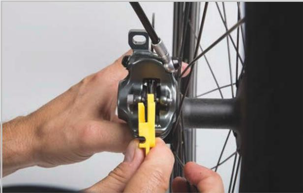
Figura 369: Controllo della guarnizione del freno nello stato montato mediante la sicura di trasporto
