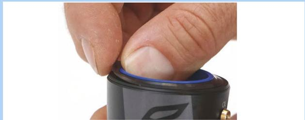
Figura 444: Estrazione dell'anello a labbro di tenuta
