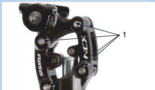
Figura 400: Punti di lubrificazione del canotto reggisella ammortizzato SR SUNTOUR
