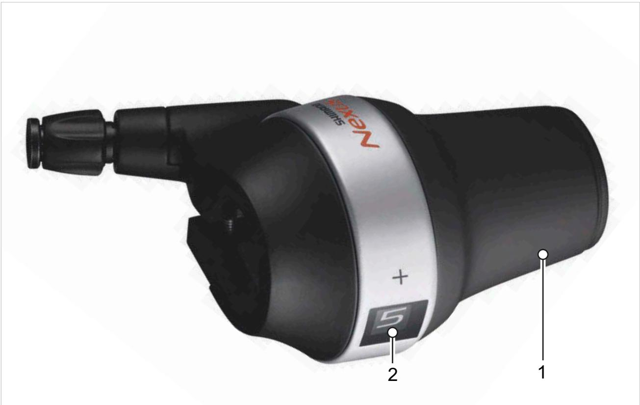
Figura 161: Manopola del cambio SHIMANO NEXUS SL-C7000-5
