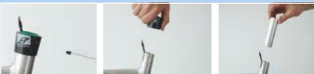
Figura 409: Smontaggio della boccola esterna e del manicotto scorrevole
