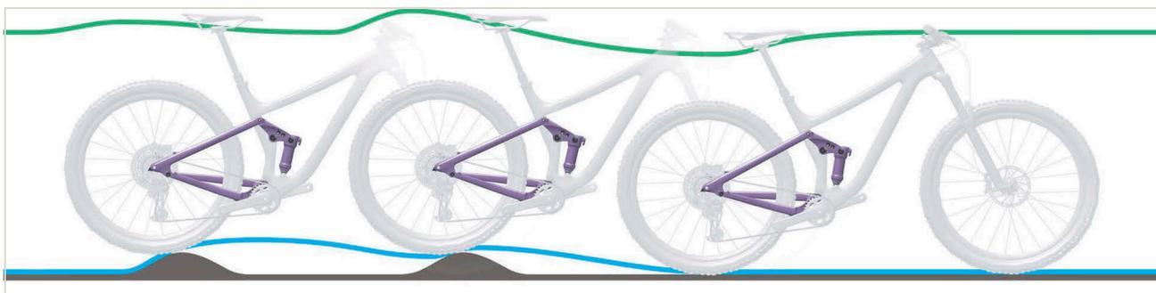
Figura 513: Corsa di estensione troppo lenta dell'ammortizzatore del carro posteriore
