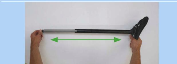
Figura 453: Estrazione completa del tubo del canotto reggisella
