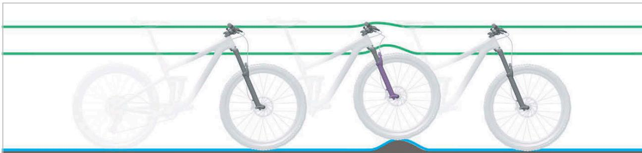
Figura 25: Comportamento di marcia ottimale della forcella ammortizzata su asperità
