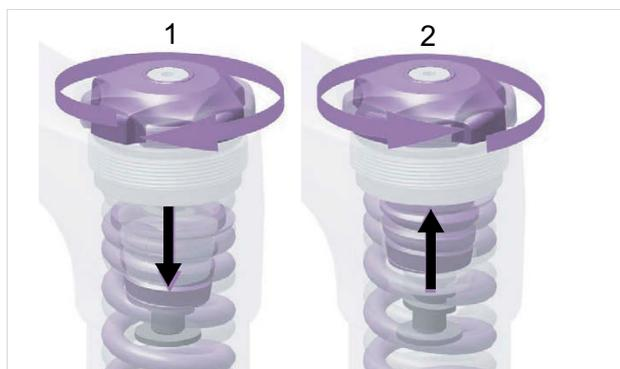
Figura 233: Avvitamento (1) e svitamento (2) della manopola di regolazione della SAG
