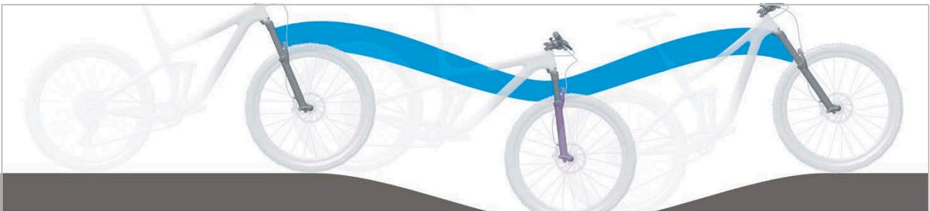
Figura 27: Comportamento di marcia ottimale su un terreno con dossi
