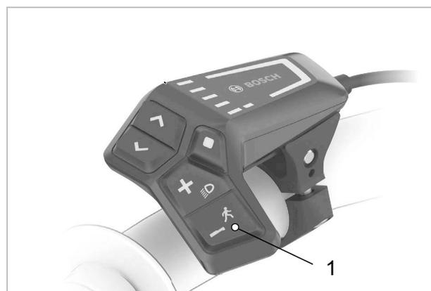
Figura 326: Ubicazione del tasto della funzione di assistenza di spinta (1)
