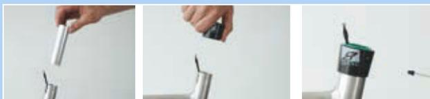
Figura 458: Montaggio del manicotto scorrevole e della boccola esterna
