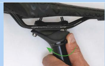
Figura 457: Chiusura della regolazione in altezza
