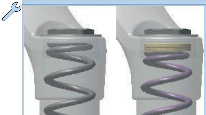
Figura 243: Avvitamento e svitamento dell'anello di regolazione del precarico
