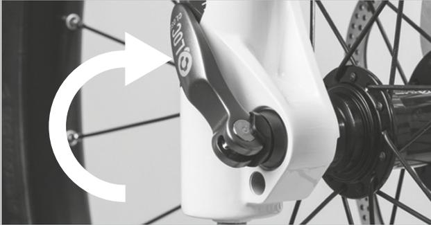
Figura 185: Chiusura del bloccaggio rapido
