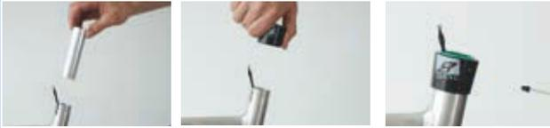
Figura 425: Montaggio del manicotto scorrevole e della boccola esterna
