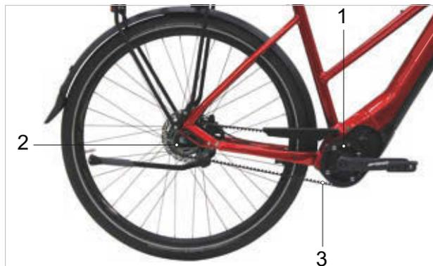
Figura 74: Schema della trasmissione a cinghia
