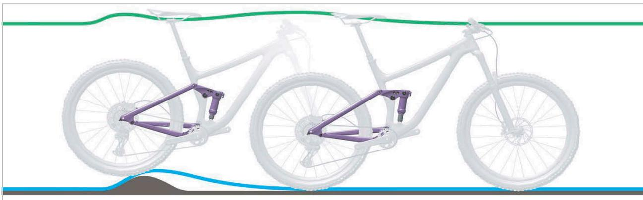
Figura 501: Smorzamento troppo duro dell'ammortizzatore del carro posteriore su asperità
