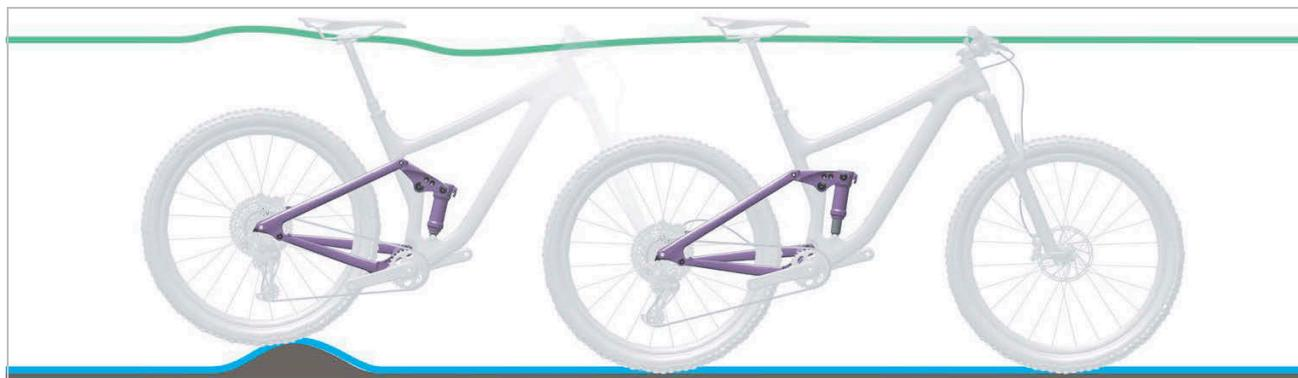
Figura 316: Comportamento di marcia ottimale dell'ammortizzatore del carro posteriore su asperità
