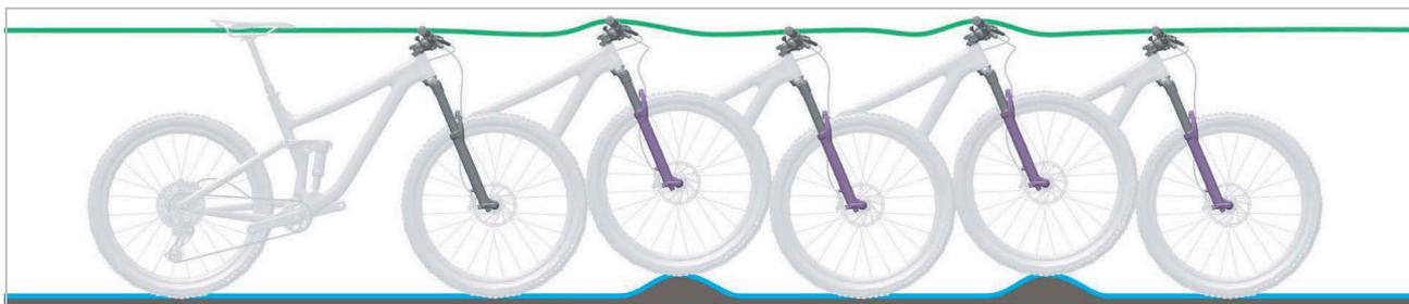
Figura 23: Comportamento di marcia ottimale della forcella ammortizzata
