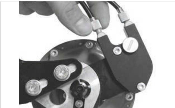
Figura 395: Le versioni del mozzo ROHLOFF con comando esterno del cambio hanno i regolatori della tensione sulla scatola dei cavi situata sul lato sinistro
