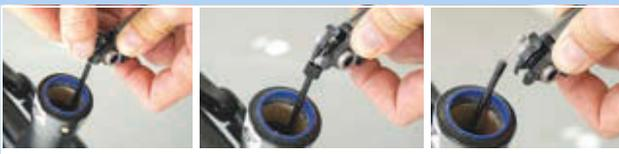
Figura 442: Rimozione del cavo meccanico
