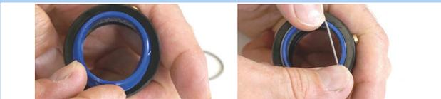
Figura 415: Applicazione e fissaggio del parapolvere
