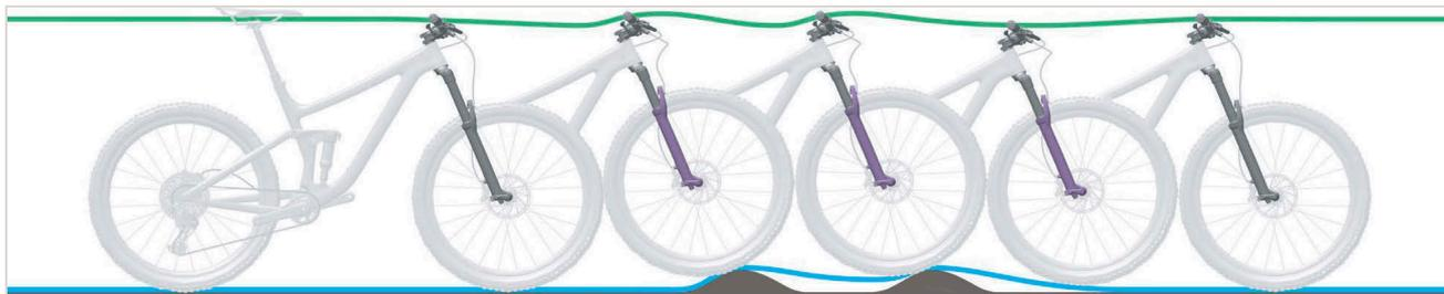
Figura 487: Corsa di estensione troppo lenta della forcella ammortizzata
