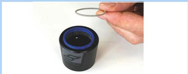
Figura 445: Anello elastico smontato
