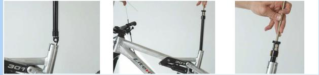
Figura 429: Fissaggio del coperchio della valvola della cartuccia
