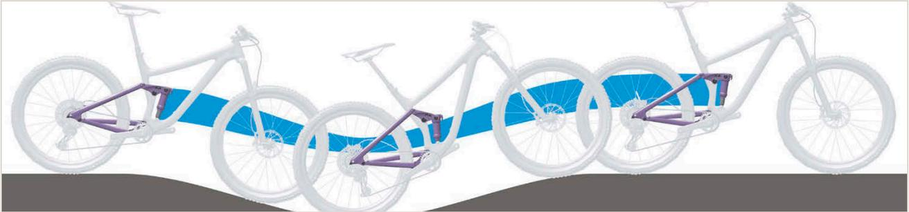
Figura 515: Sospensione dell'ammortizzatore del carro posteriore troppo morbida in salita
