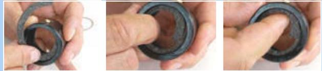
Figura 449: Applicazione dell'anello di feltro
