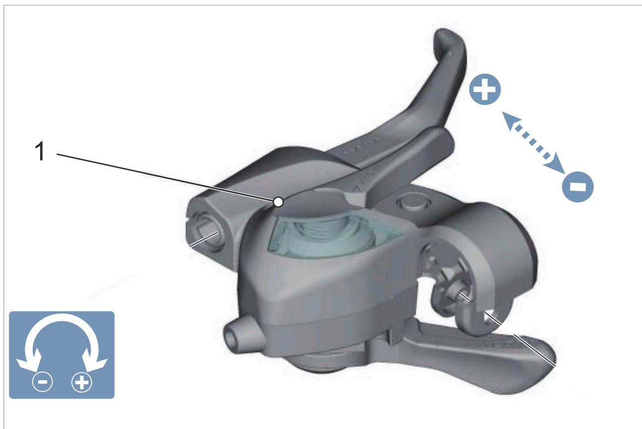
Figura 227: Posizione della vite di regolazione (1)
