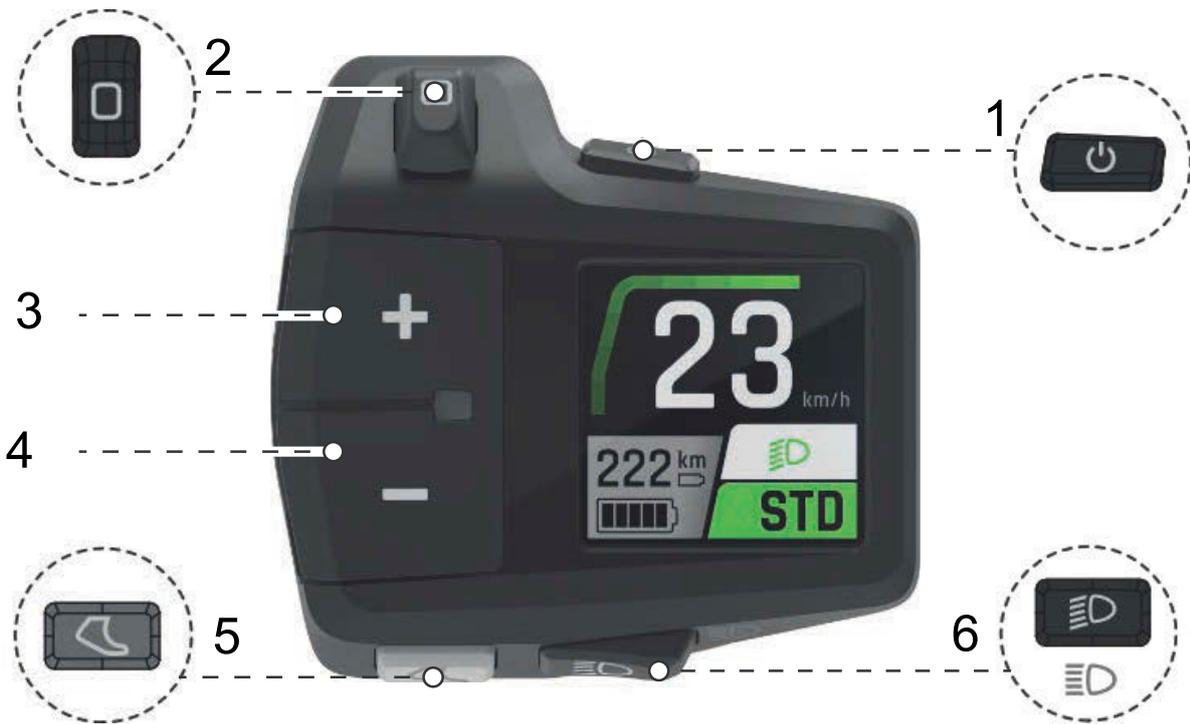
Figura 147: Schema del terminale di comando FIT LED Remote
