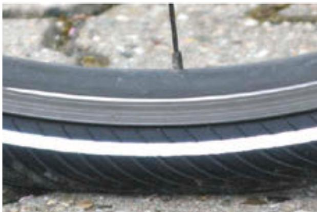
**Figura 216: Corretta pressione di gonfiaggio. Lo pneumatico quasi non si deforma sotto il peso corporeo**
