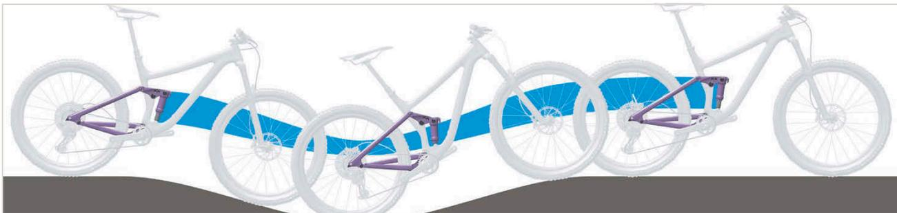
Figura 507: Sospensione dell'ammortizzatore del carro posteriore troppo morbida in salita
