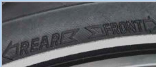
Figura 171: Freccia del senso di rotazione su pneumatici MTB
