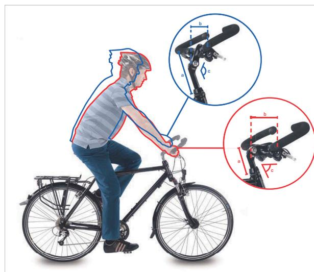
Figura 214: Posizione per bicicletta da città (blu) e per bicicletta da trekking (rosso) tramite modifica dell'angolo
