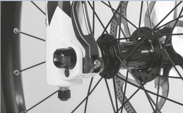
Figura 180: Corretta posizione della leva di serraggio
