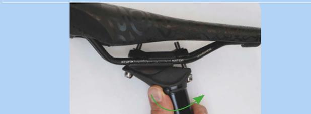
Figura 452: Apertura della regolazione in altezza
