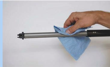
Figura 454: Pulizia della scanalatura di guida longitudinale
