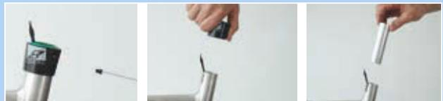
Figura 443: Smontaggio della boccola esterna e del manicotto scorrevole
