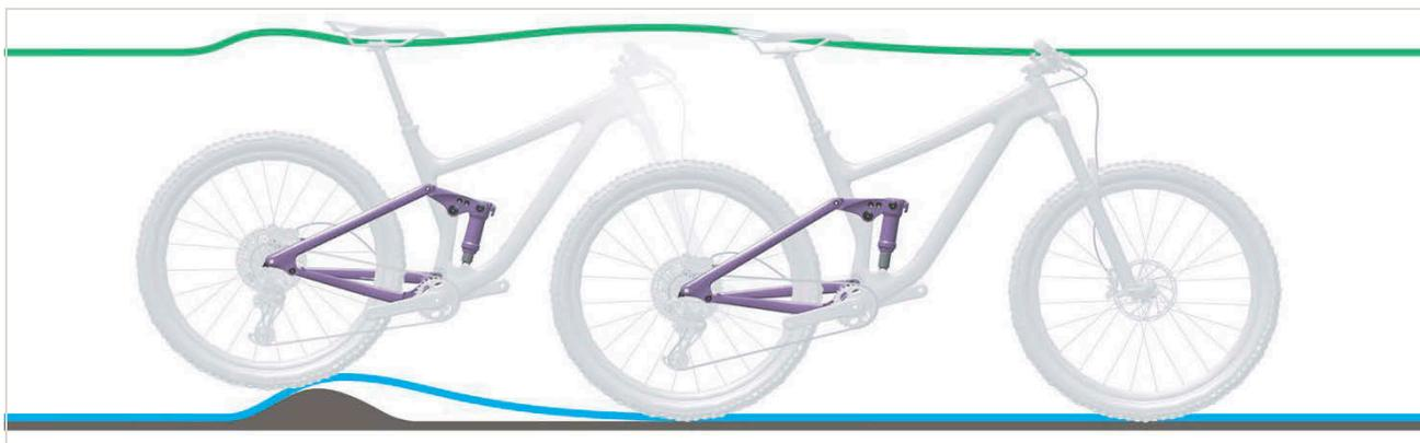
Figura 517: Smorzamento troppo duro dell'ammortizzatore del carro posteriore su asperità
