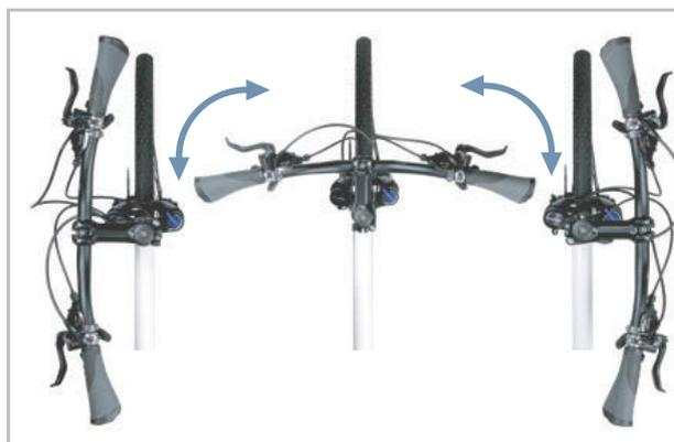
Figura 17: Funzione Twist, esempio BY.SCHULZ
