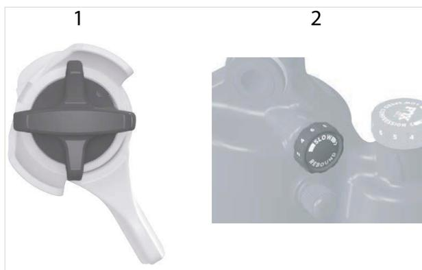
Figura 256: Regolatore del rebound Float DPS (1) e Float X (2)
