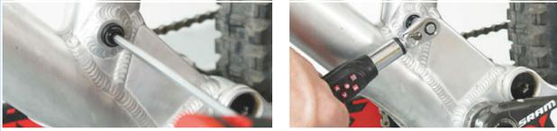
Figura 431: Fissaggio del perno Postpin
