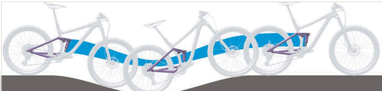
Figura 499: Sospensione dell'ammortizzatore del carro posteriore troppo morbida in salita
