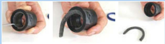
Figura 412: Rimozione dell'anello di feltro
