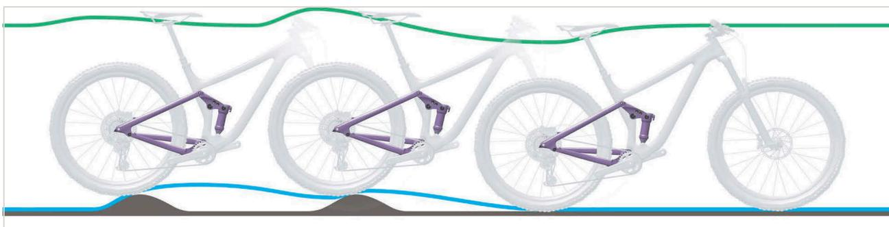
Figura 497: Corsa di estensione troppo lenta dell'ammortizzatore del carro posteriore
