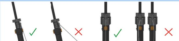
Figura 428: Cavo meccanico corretto ed errato
