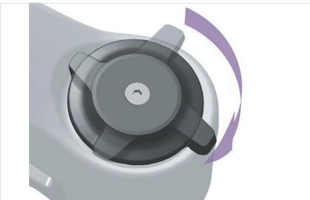
Figura 482: Regolazione più rigida del regolatore dello stadio di compressione
