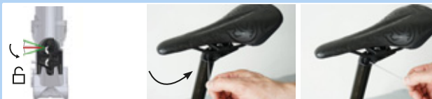
Afbeelding 147: Bediening hoogteverstelling in stand "geopend" zetten
