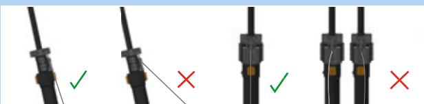
Afbeelding 174: Correcte en verkeerde bowdenkabel
