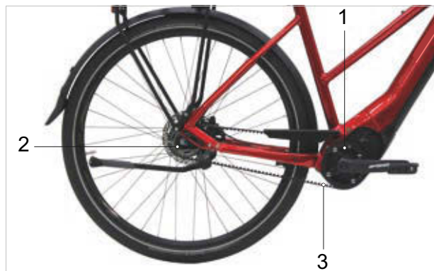
74 paveikslėlis. Diržinės pavaros schema
