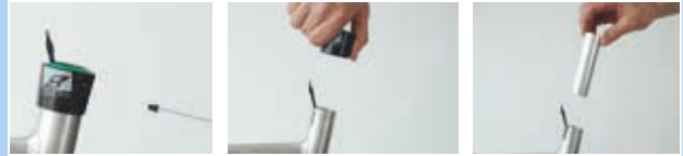
443 paveikslėlis. Išorinės movos ir slankiosios įvorės išmontavimas
