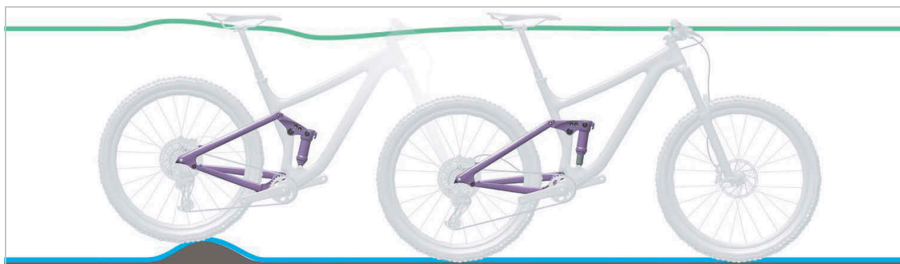
316 paveikslėlis. Optimali galinio amortizatoriaus važiavimo charakteristika važiuojant per nelygumus
