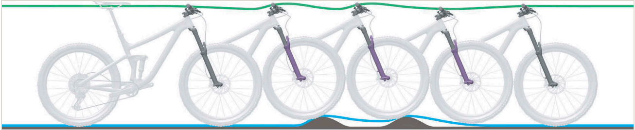
487 paveikslėlis. Per lėtas amortizuojančių šakių atšokimas
