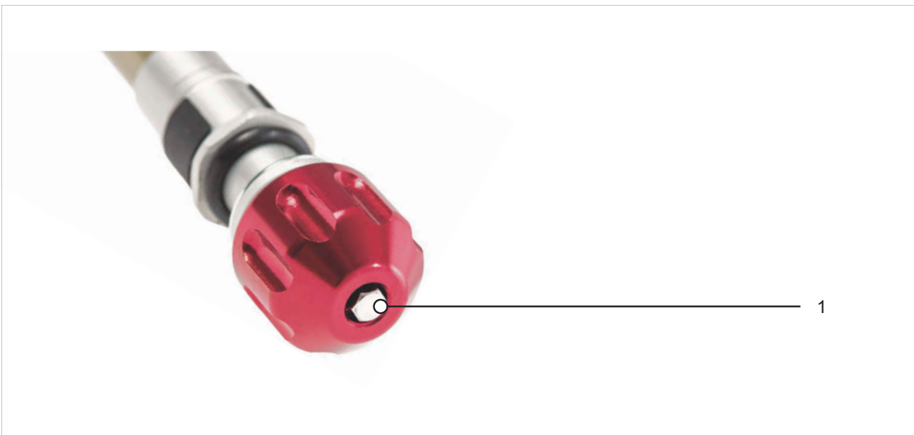
472 paveikslėlis. SR Suntour atšokimo reguliatoriaus (šakė) (1) pavyzdys
