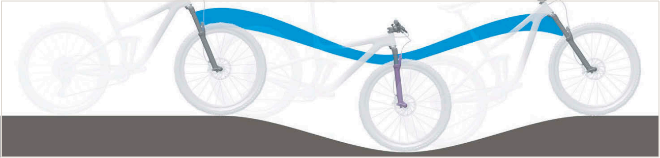
481 paveikslėlis. Per minkštas amortizuojančios šakės amortizavimas ant kalno
