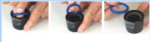
411 paveikslėlis. Grandiklio ištraukimas
