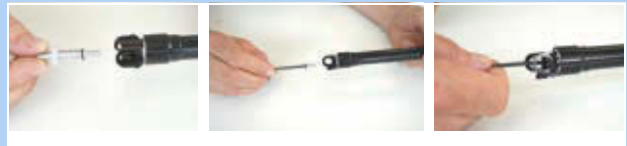
424 paveikslėlis. Kasetės vožtuvo dangtelio pritvirtinimas
