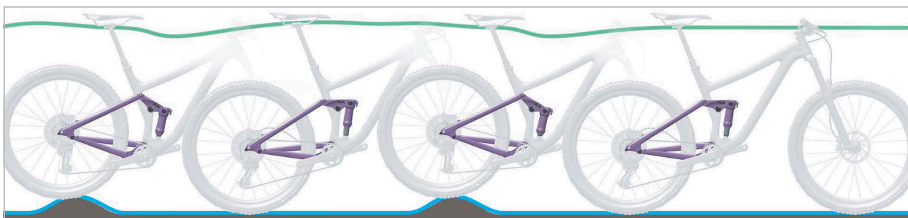
8 paveikslėlis. Optimali galinio amortizatoriaus važiavimo charakteristika
