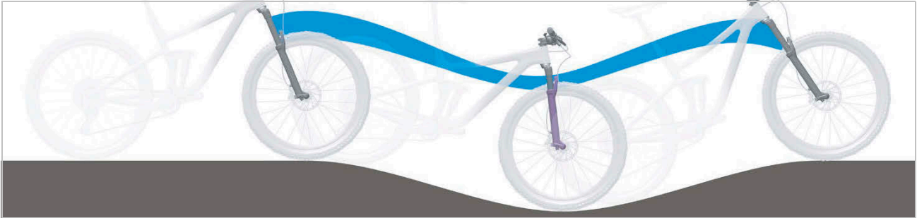
475 paveikslėlis. Ant kalno šakių amortizavimas per minkštas
