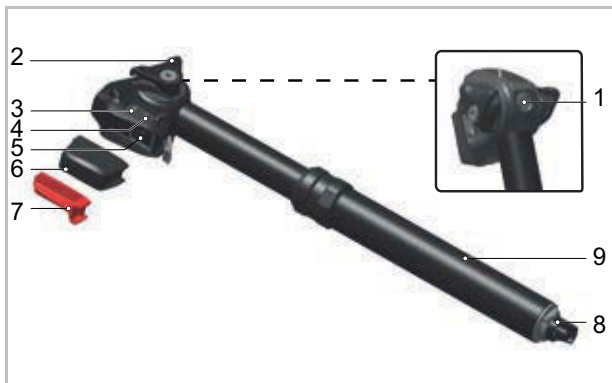
70 paveikslėlis. ROCKSHOX „Reverb AXS“ balnelio stovo konstrukcija
