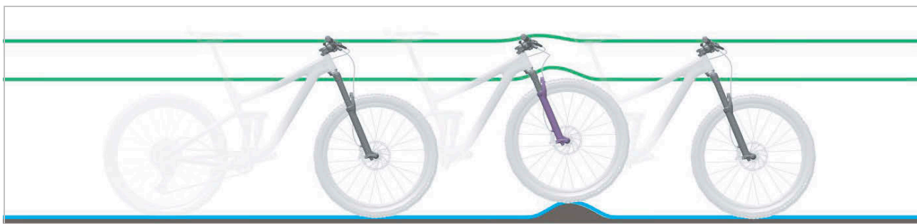
25 paveikslėlis. Optimali amortizuojančios šakės važiavimo charakteristika nelygumuose
