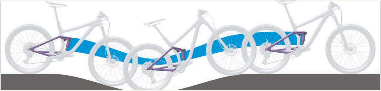
515 paveikslėlis. Ant kalno galinio amortizatoriaus amortizavimas per minkštas
