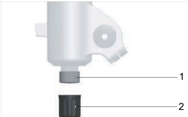
488 paveikslėlis. FOX atšokimo pakopos reguliatorius (šakė) (1) po šakės dangteliu (2)
