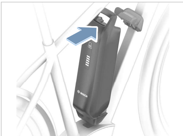
300 paveikslėlis. Atverskite „PowerPack“ į viršų
