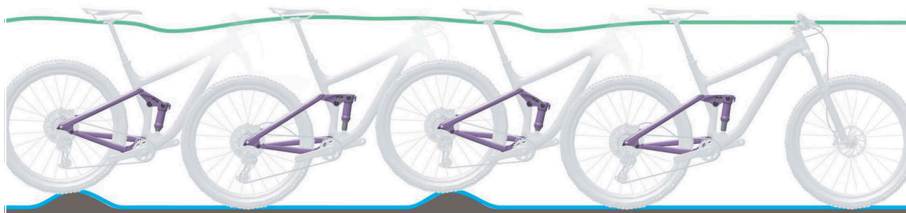
9 paveikslėlis. Optimali galinio amortizatoriaus važiavimo charakteristika
