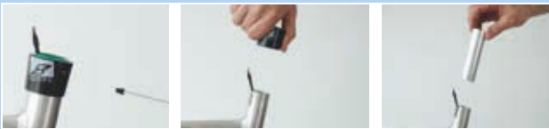
409 paveikslėlis. Išorinės movos ir slankiosios įvorės išmontavimas
