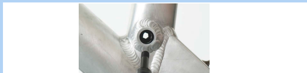
430 paveikslėlis. Kasetės vožtuvo dangtelio pritvirtinimas
