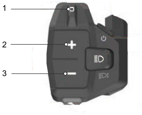
275 paveikslėlis. Vietos naršymo svirties (1), pliuso (2) ir minuso (3) mygtukai
