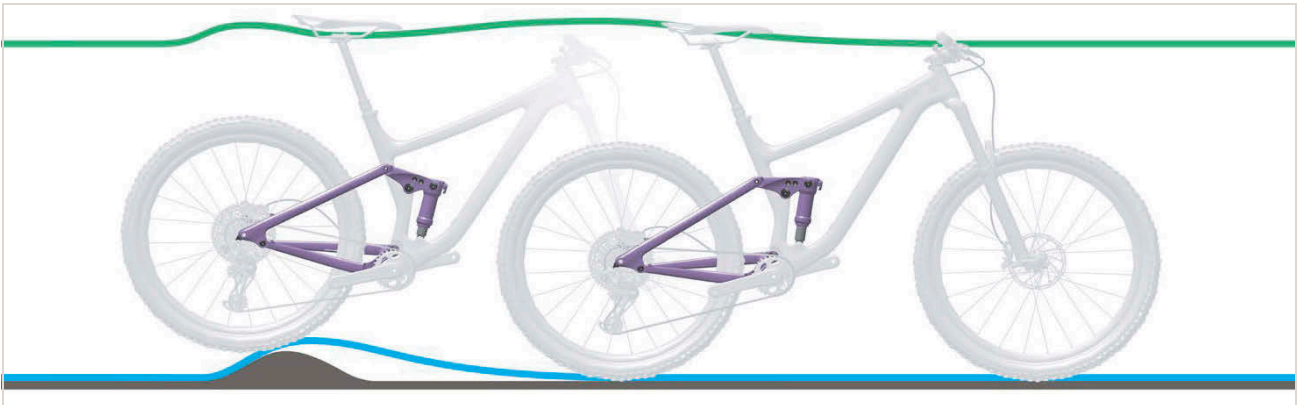
517 paveikslėlis. Per kietas galinio amortizatoriaus amortizavimas nelygumuose
