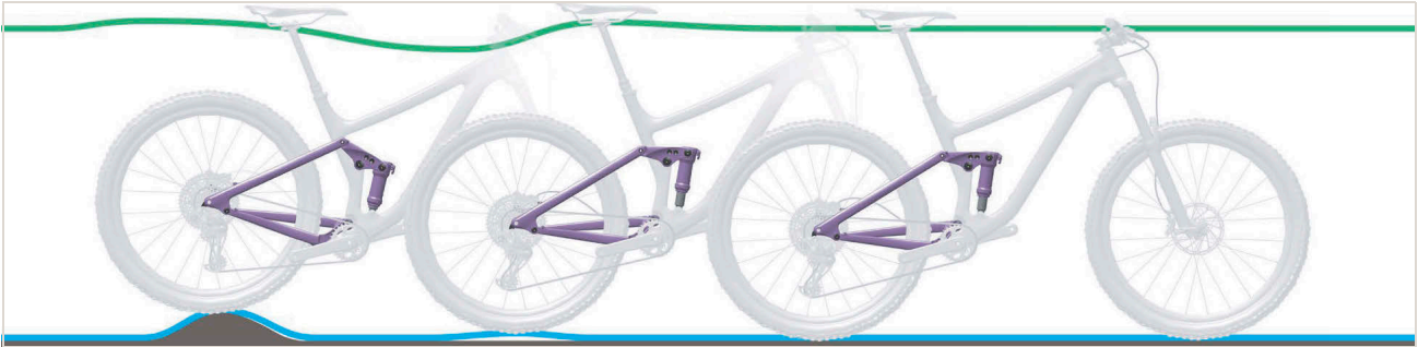
511 paveikslėlis. Per greitas galinio amortizatoriaus atšokimas
