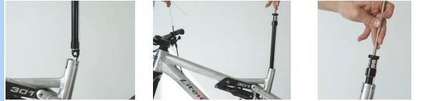
429 paveikslėlis. Kasetės vožtuvo dangtelio pritvirtinimas
