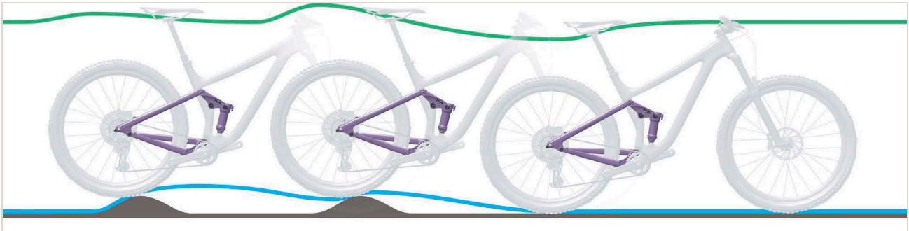
513 paveikslėlis. Per lėtas galinio amortizatoriaus atšokimas
