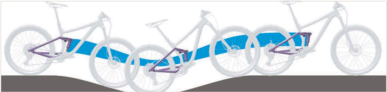
507 paveikslėlis. Per minkštas galinio amortizatoriaus amortizavimas ant kalno
