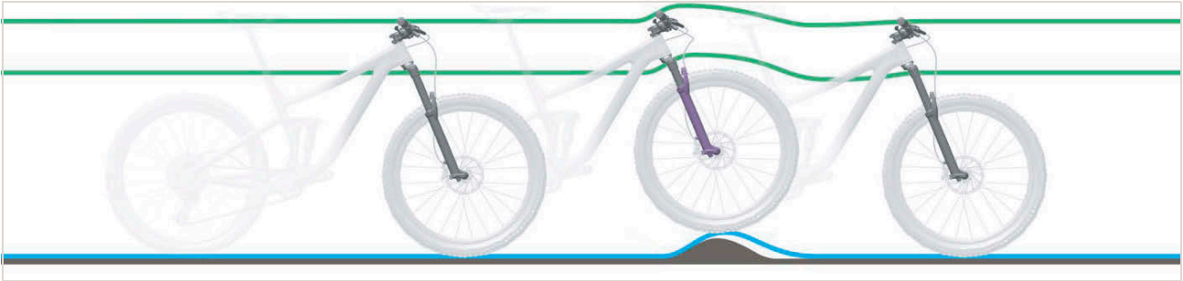
492 paveikslėlis. Per kietas amortizuojančių šakių slopinimas nelygumuose
