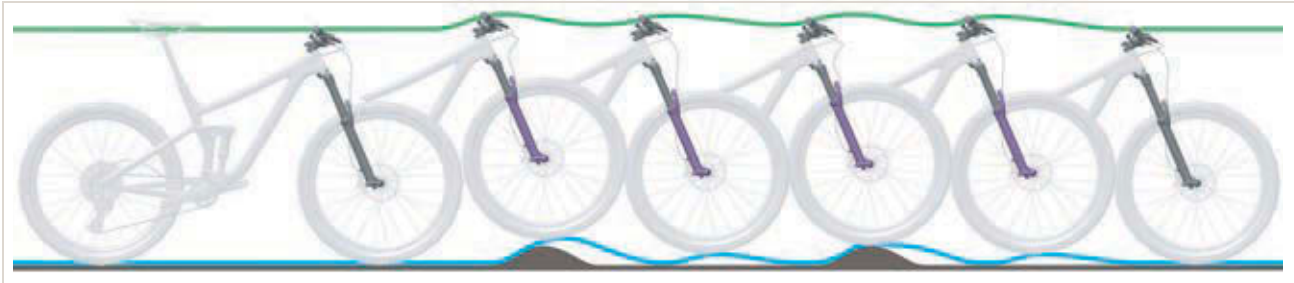
485 paveikslėlis. Per greitas amortizuojančių šakių atšokimas
