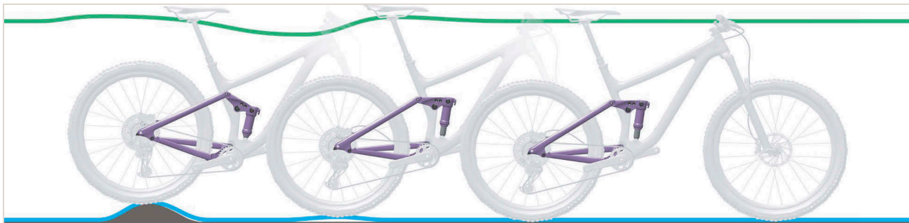
503 paveikslėlis. Per greitas galinio amortizatoriaus atšokimas
