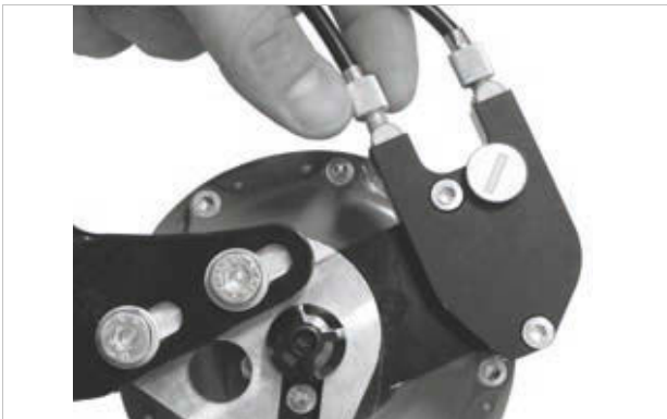
395 paveikslėlis. ROHLOFF stebulės variantas su išoriniu perjungimo valdymu turi įtempimo reguliatorius ant kabelių dėžės kairėje
