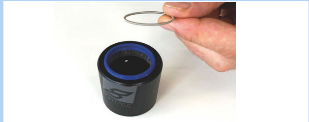
410 paveikslėlis. Nuimta spyruoklinė poveržlė
