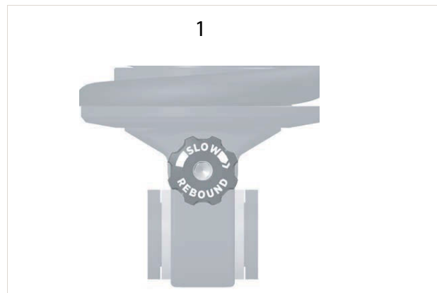
257 paveikslėlis. Atšokimo pakopos reguliatorius Float DHX (1)
